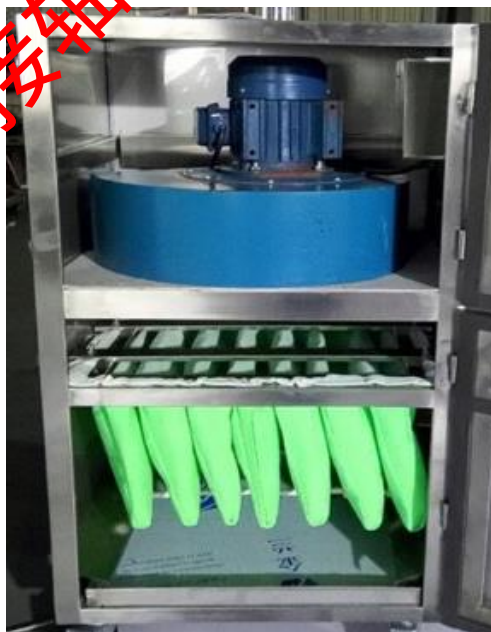
图 4.2 移动式烟尘净化器内部构造图
