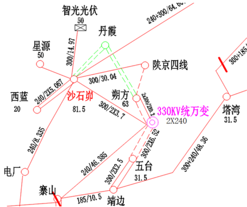
图1 拟建变电站与周边电网接入方案示意图
