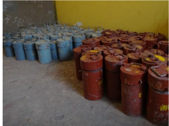
河南双辐公司放射源储存库内放射源及放射性同位素采用铅罐储存
